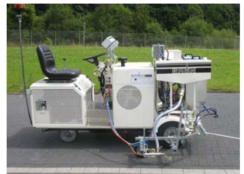
VARIOZET – 4 с модулем по нанесению безвоздушным способом хсп 1:1
