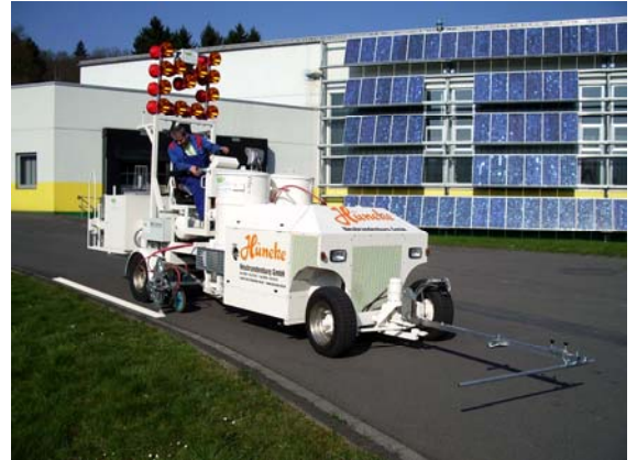
COMBIZET - 3S Тип 1:1- с модулем по нанесению безвоздушным способом хсп 1:1
