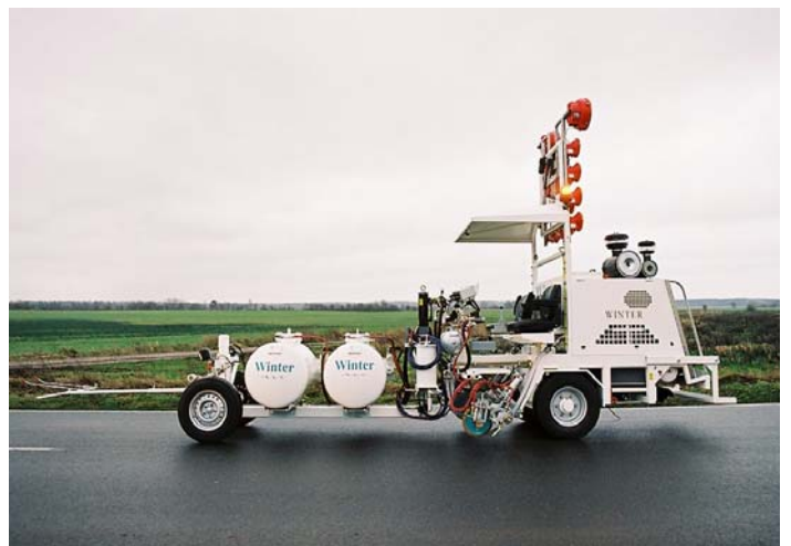
WP 1000 – безвоздушный способ нанесения материала
