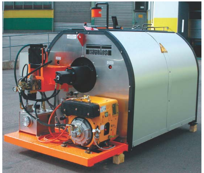
Серия котлов RTK с горизонтальным валом мешалки.
